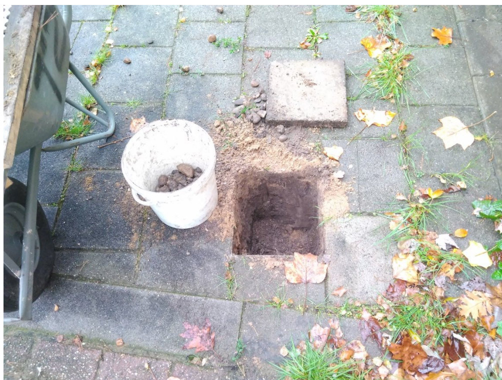
Foto 6: gat G4 met uitkomend grof materiaal, fractie > 20 mm
