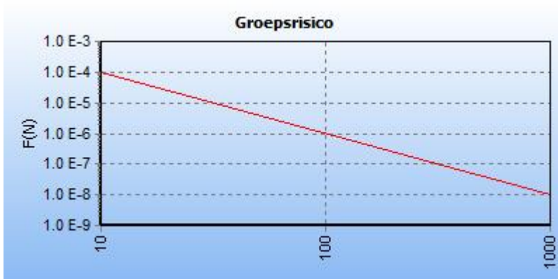
5.2 Figuur 5.2 FN curve voor 8496_leiding-W-526-03-deel-1 van N.V. Nederlandse Gasunie voor de kilometer tussen stationing 0.00 en stationing 30.00
