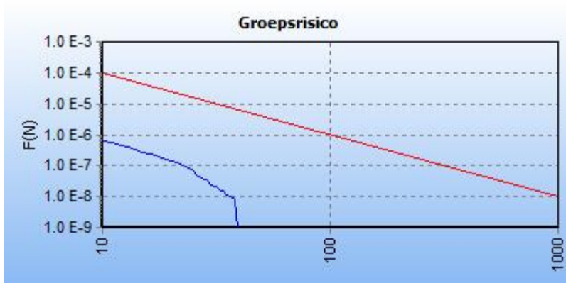
5.2 Figuur 5.2 FN curve voor 8496_leiding-W-526-03-deel-1 van N.V. Nederlandse Gasunie voor de kilometer tussen stationing 0.00 en stationing 30.00
