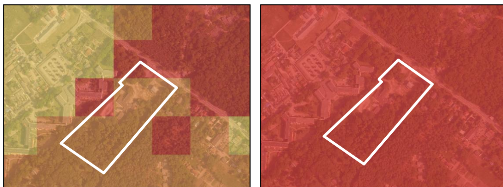
Links: gemiddeld hoogste grondwaterstand onder het maaiveld. Rechts: gemiddeld laagste grondwaterstand onder het maaiveld. Geel: 0,8 - 1,2 meter; oranje: 1,2 - 1,6 meter; rood: > 1,6 meter. Plangebied wit omkaderd.
