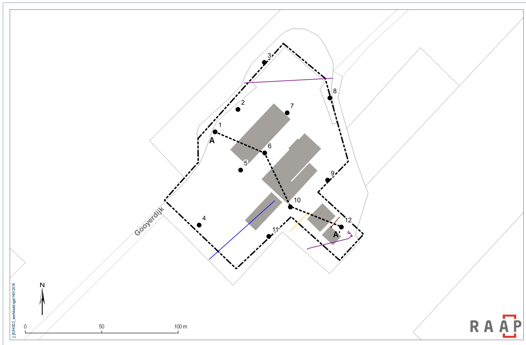
Figuur 6. Boorpuntenkaart met de ligging van de boorraai A-A' en de aanwezige kabels en leidingen.
