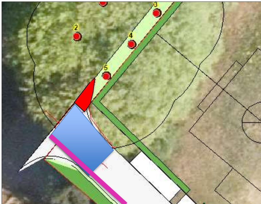
Afbeelding 29: Rood: minimaal graven i.v.m. intensieve beworteling. Blauw: gedeelte van de ontsluitingsweg gefundeerd met boomkratten. Paars: riolering aan buitenzijde weg;
