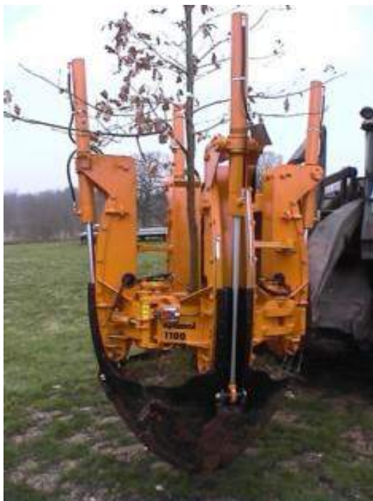
Inzet van verplantmachines met het Optimal-systeem.
