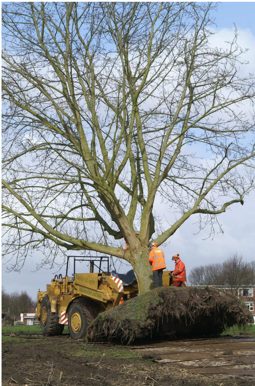
Verplanting van een grote vleugelnoot in Dronten met behulp van de grote verplantschep.
