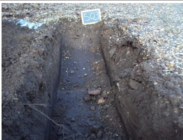
Foto Asbestinspectiesleuf S03
