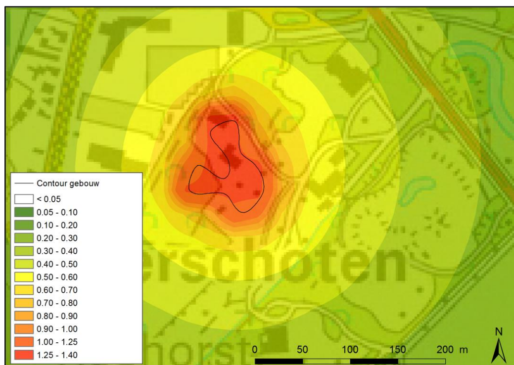
Figuur 4: Verlaging grondwaterstand gedurende GHG situatie op de laatste dag van bemaling
