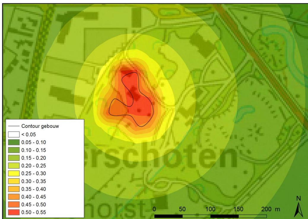
Figuur 2: Verlaging grondwaterstand gedurende GLG situatie op de laatste dag van bemaling
