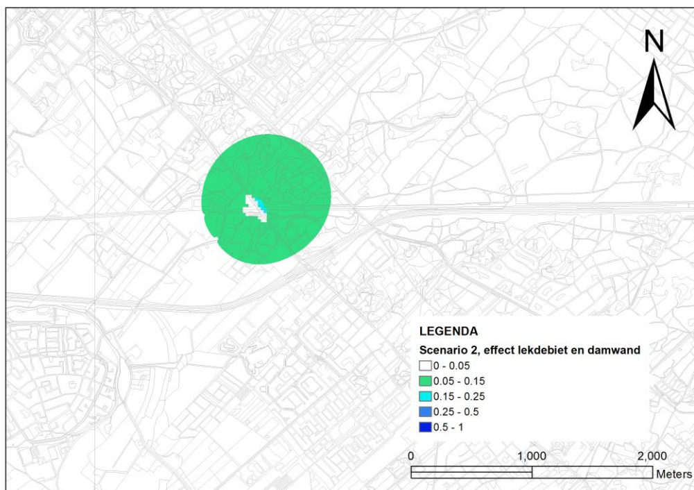
Afbeelding 5 grondwaterstandsverlaging bij lekdebiet door onderwaterbeton verdiept stationsplein en hoofdstraat
