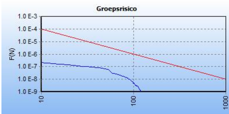
5.1 Figuur 5.1 FN curve bestaande situatie voor 8740_leiding-A-510-deel-1 van N.V. Nederlandse Gasunie voor de kilometer tussen stationing 2420.00 en stationing 3420.00
