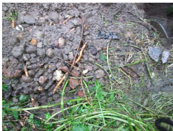
Foto 10: Grove fractie uit gat 10 met rechts de aangetroffen 2 stukjes asbestverdacht materiaal
