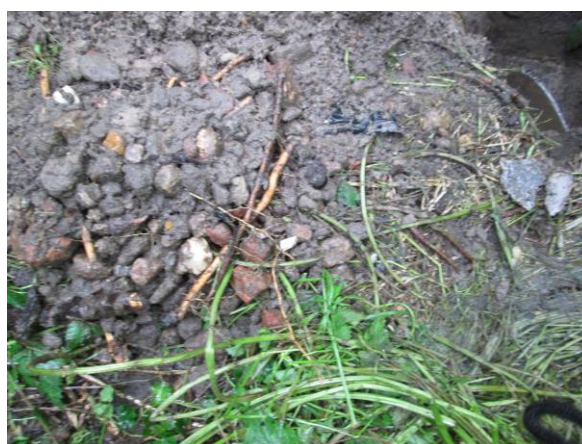
Foto 10: Grove fractie uit gat 10 met rechts de aangetroffen 2 stukjes asbestverdacht materiaal
