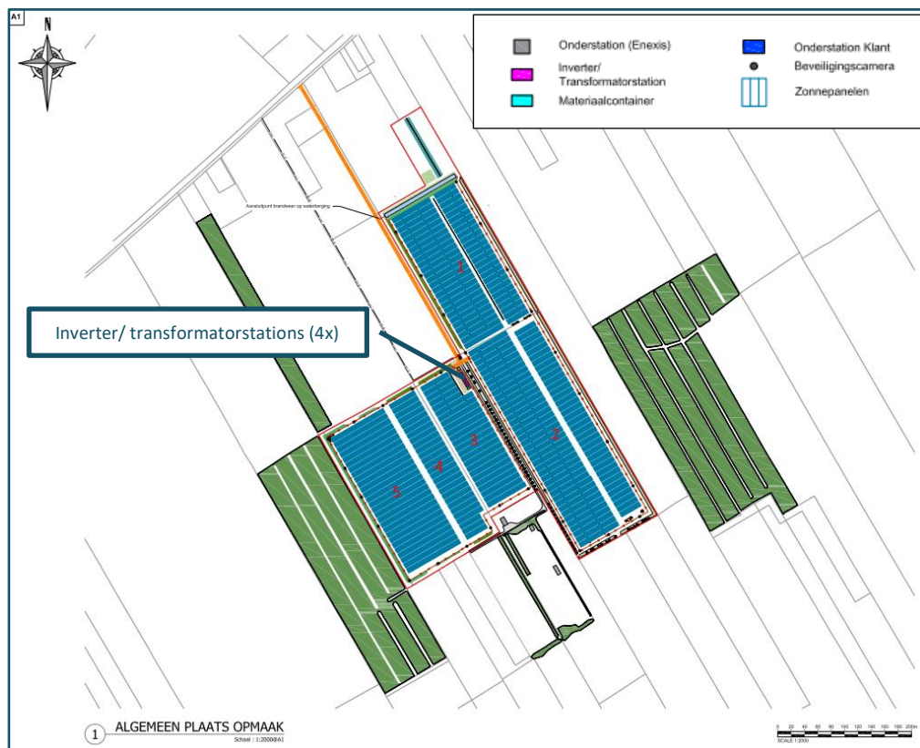
Figuur 2 Schematische weergave van het zonneveld.
