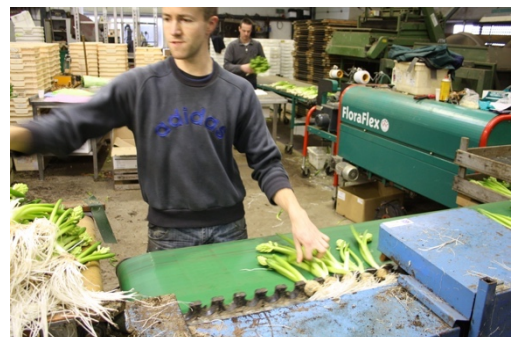
Figuur 3: Het handmatig inleggen van de hyacinten in de uitsnijdmachine
