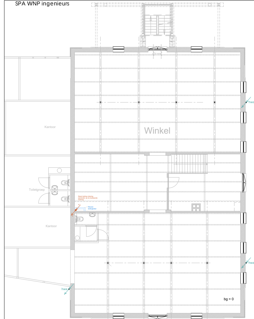
NIEUWE TOESTAND BEGANEGROUND RIOLERING EN VENTILATIE SCHAAL 1:100
