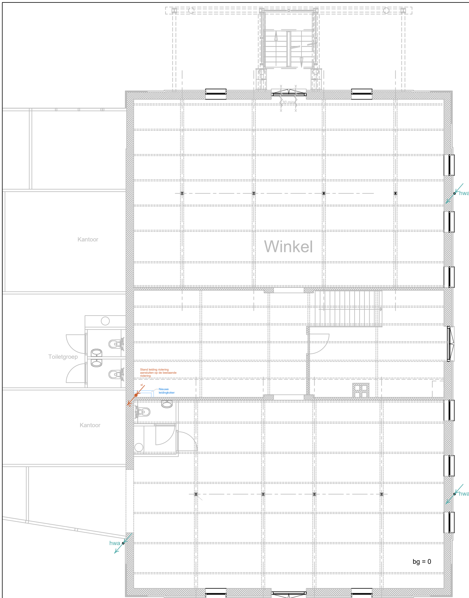
NIEUWE TOESTAND BEGANEGROUND RIOLERING EN VENTILATIE SCHAAL 1:100
