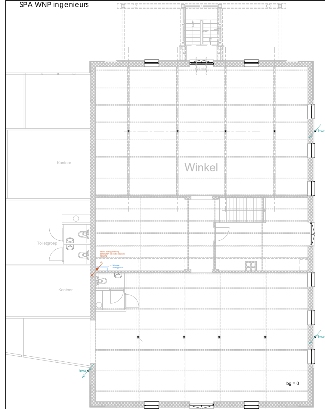
NIEUWE TOESTAND BEGANEGROUND RIOLERING EN VENTILATIE SCHAAL 1:100
