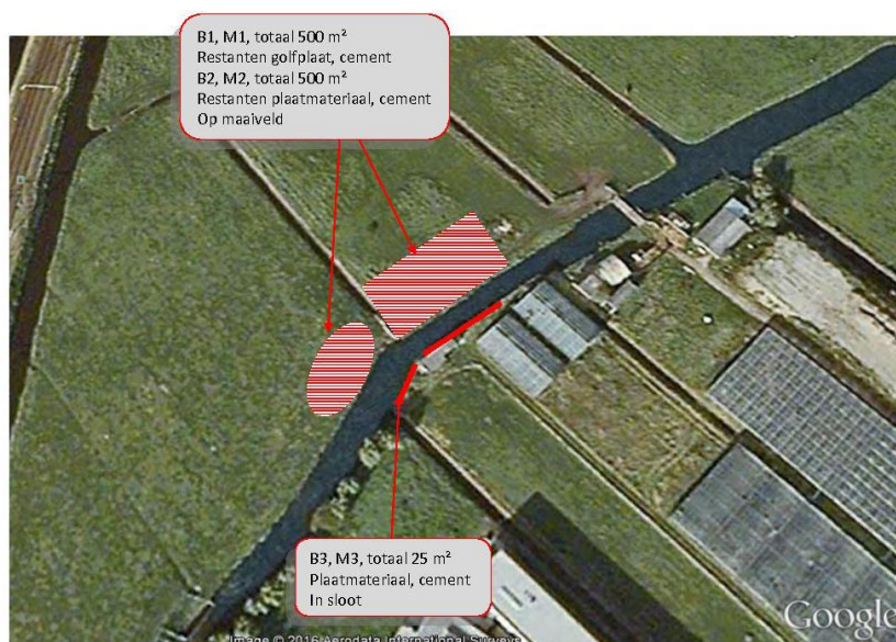
Afbeelding 10: Locatie asbesthoudende toepassingen.
