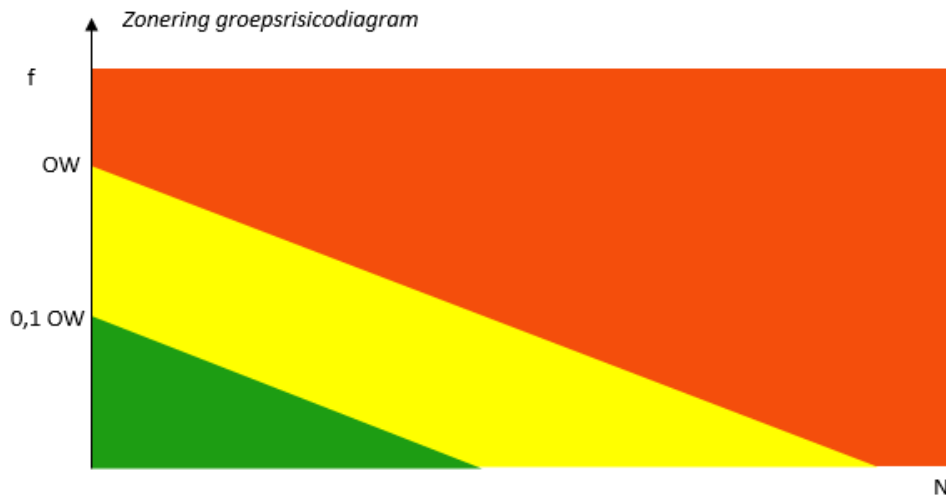
Figuur Zonering groepsrisicodiagram (fN diagram: f= kans op calamiteit, N=aantal slachtoffers)
