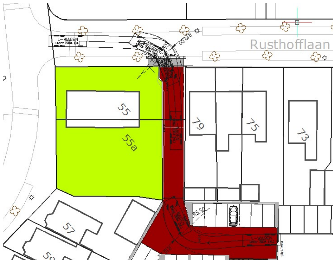
Afbeelding 6 Rijcurve simulatie brandweerwagen
