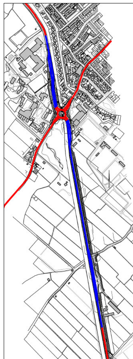
Figuur 5.1: Wegdelen waar geluidreducerend asfalt wordt toegepast (weergegeven in blauw)
