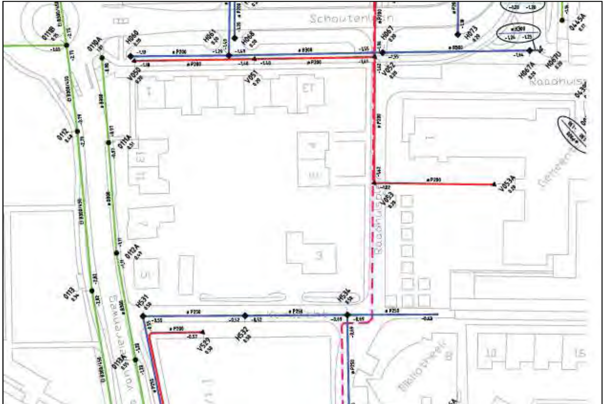
Figuur 5. Rioleringstekening (bron: gemeente Teylingen).
