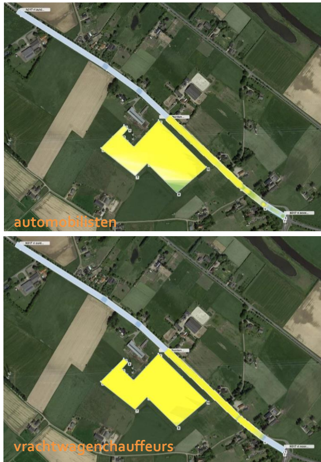
Figuur 4.2: Schitterende delen van de zonnepanelen die tot hinder kunnen leiden en waar op de route deze hinder zichtbaar is. Boven voor automobilisten, onder voor vrachtwagenchauffeurs. Hoe geler de kleur, hoe meer reflectie.
