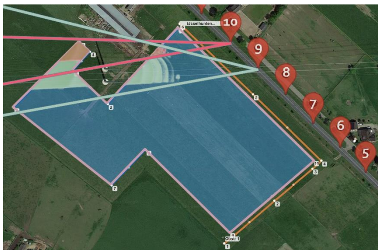
Figuur 4.9: Schitterende delen van de zonnepanelen met hulplijnen die aangegeven waar de reflectie vandaan komt op de verschillende observatiepunten waar reflectie kan worden waargenomen.
