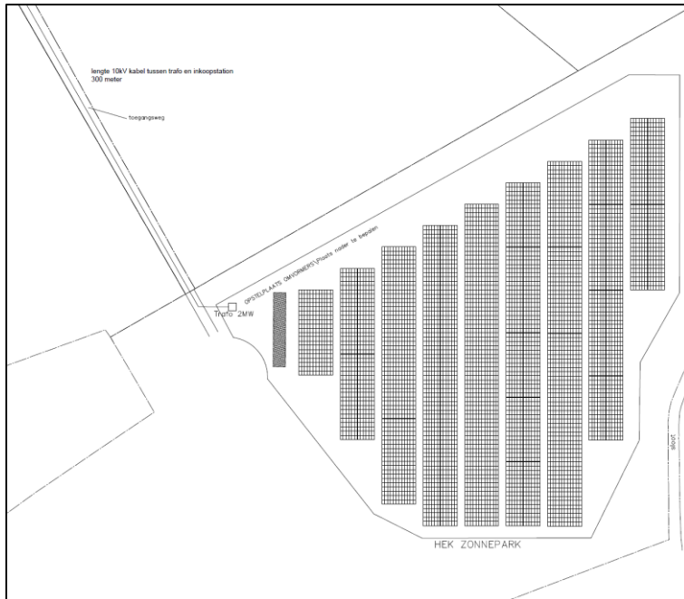
Figuur 12 situering van de gewenste zonnepanelen
