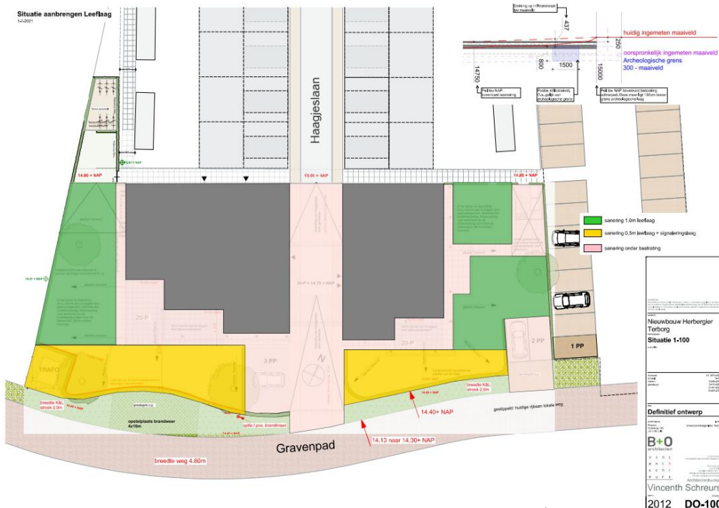
Figuur 11: overzicht van te ontgraven diepten op het projectgebied
