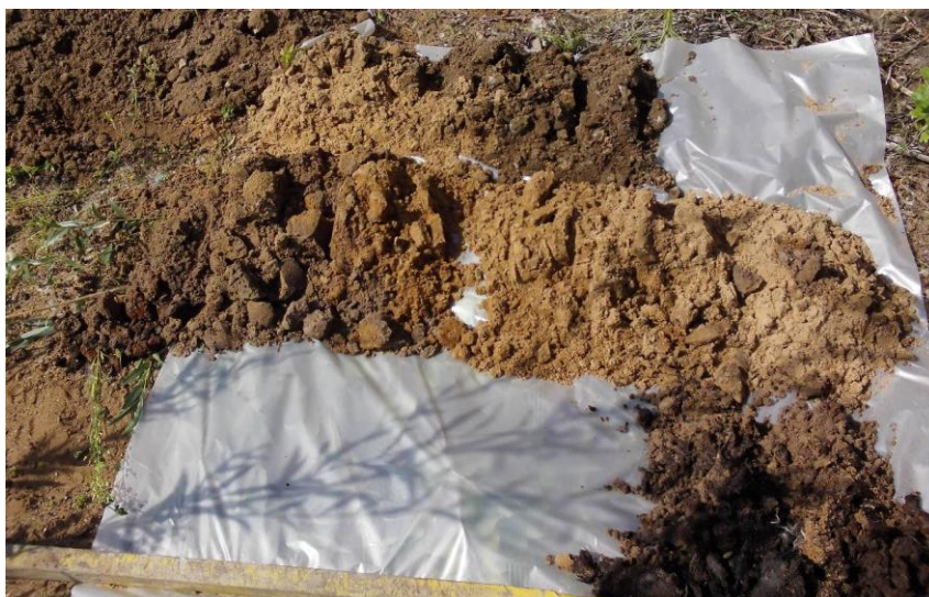
Afbeelding 3.1: Boorprofiel ter plaatse van boring 1 (foto: Greenhouse Advies).
