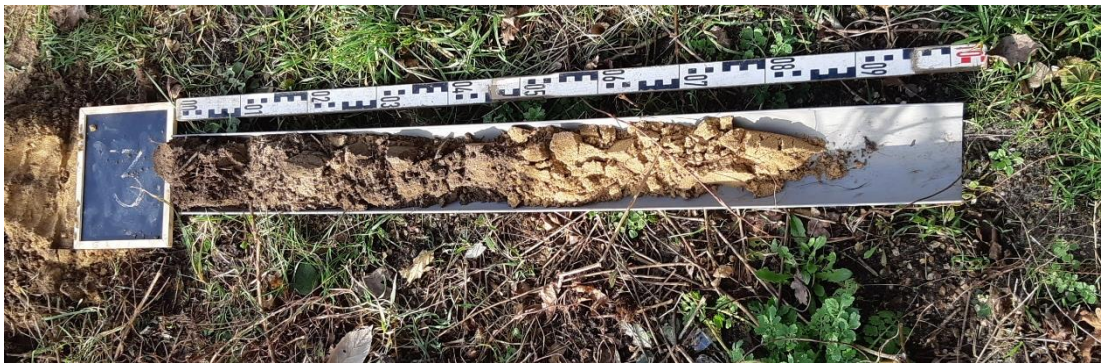
Afbeelding 22: Foto van het bodemprofiel van boring 3 met v.l.n.r. de bruine bouwvoor, de grijsbruine sterk gevlekte subrecente ophooglaag en vanaf 50 cm-mv de gele rivierduinafzettingen.
