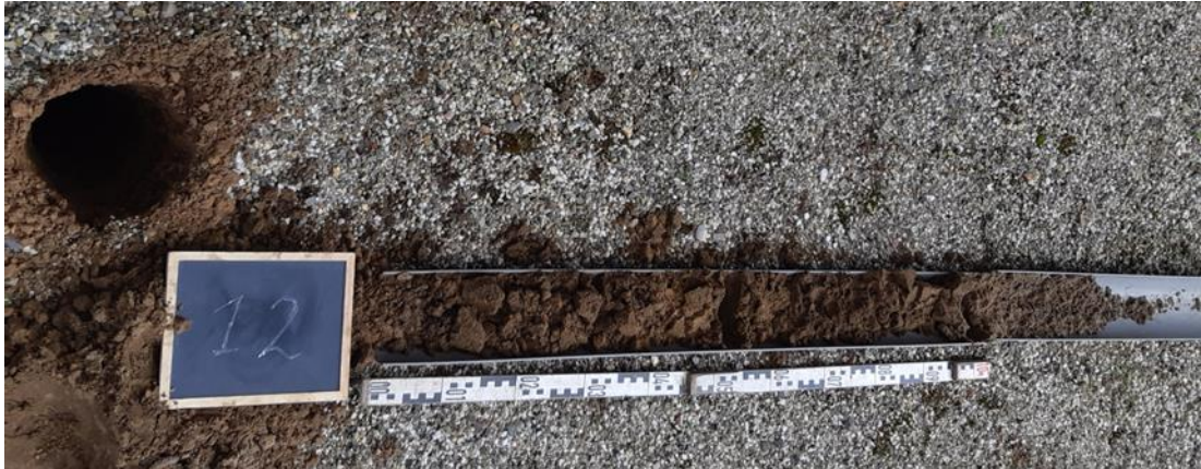
Afbeelding 21: Foto van het bodemprofiel van boring 12 met v.l.n.r. de grindophoging, de grijsbruin gevlekte ophooglaag (Ap1), het lichtbruine homogene plaggendeek en vanaf 95 cm-mv de grijze rivierduinafzettingen.
