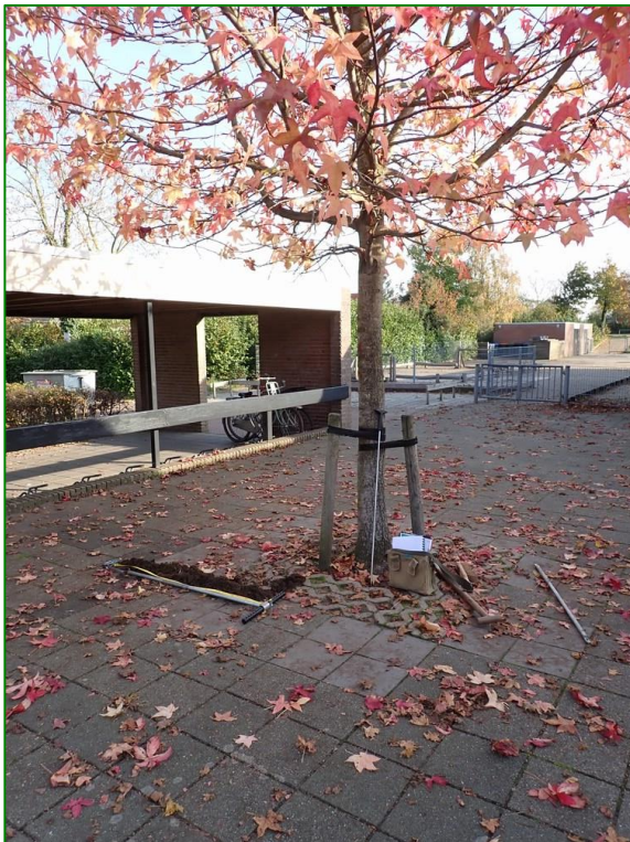
Foto 3: grondboring in het met grasbetontegels bestrate plantvak
