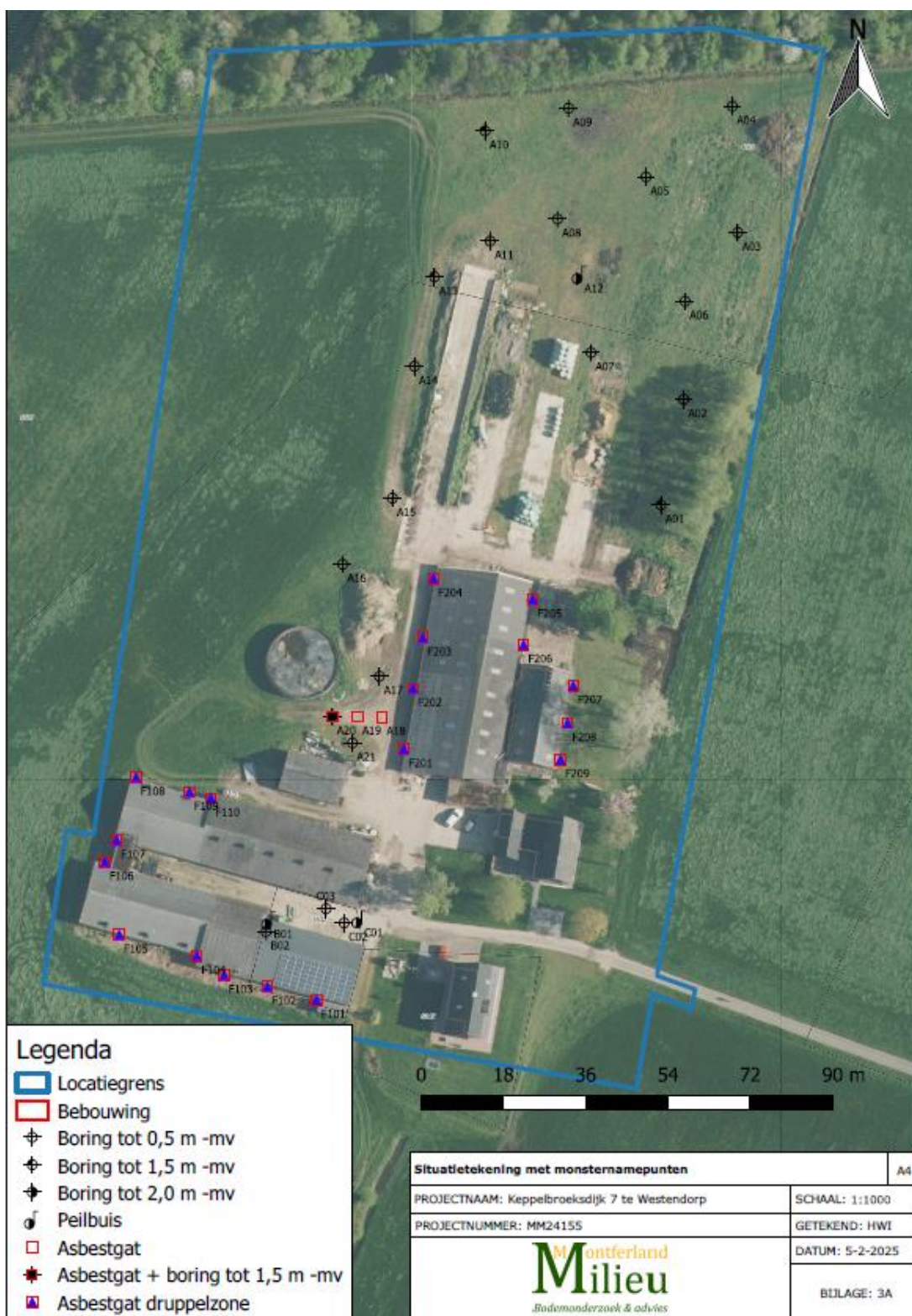
Figuur 3 Situatietekening met boorpunten/gaten
