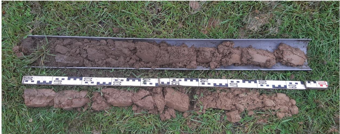
Afbeelding 12; Foto van het boorprofiel van boring 1 met van boven naar onder en v.l.n.r. de grijsbruine bouwvoor, de bruingrijze ploegvoor, grijze matig gerijpte zandige klei en vanaf 155 cm-mv fijn grijs dekzand.
