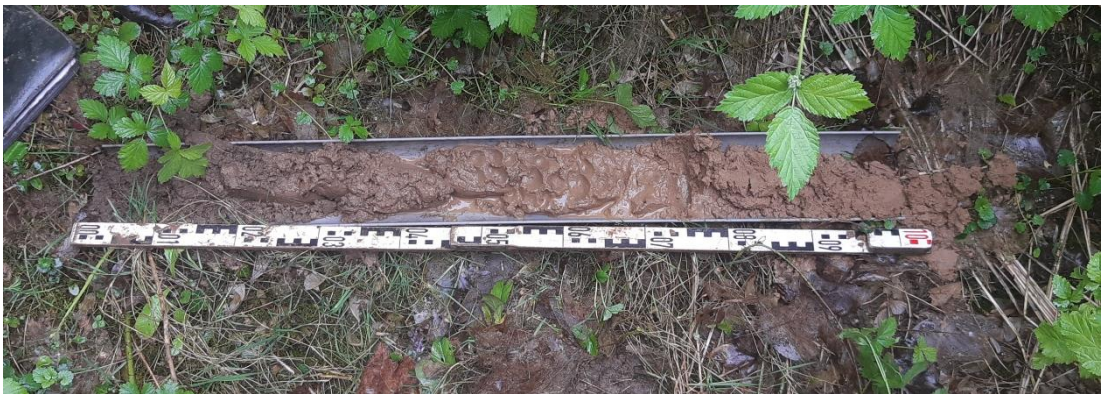
Afbeelding 13; Foto van het boorprofiel van boring 4 met v.l.n.r. de bruingrijze gevlekte bouwvoor, grijze matig gerijpte iets zandige klei en vanaf 75 cm-mv grijs fijn dekzand.
