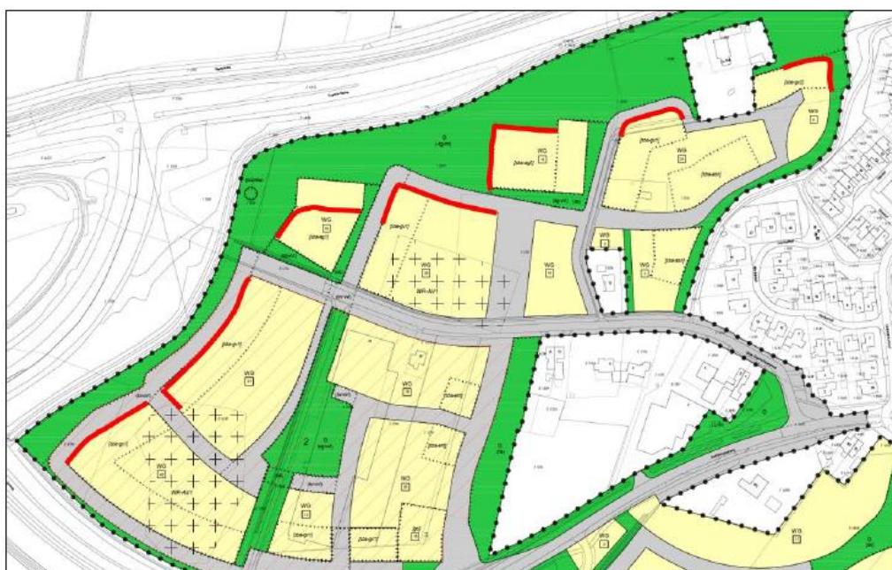
Dove gevel markering, rood: hele gevel doof
