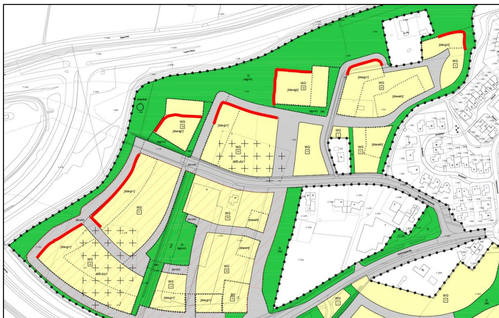
Dove gevel markering: rood: hele gevel doof
