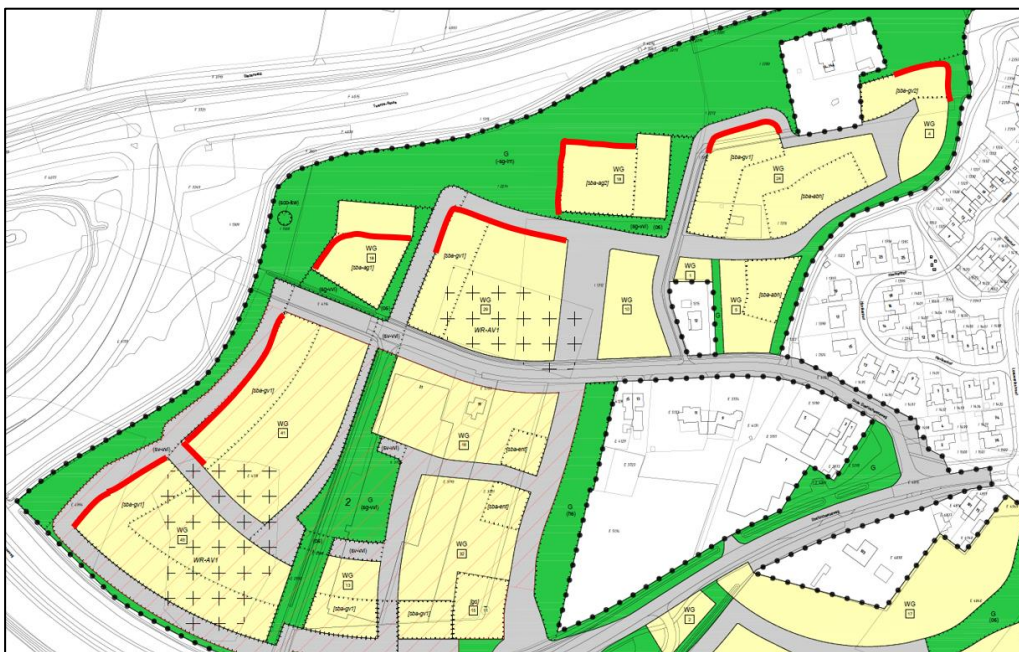
Dove gevel markering: rood: hele gevel doof
