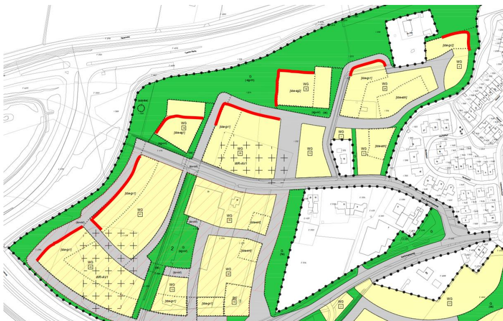
Verbeelding met in rood gevels met een geluidbelasting hoger dan 53 dB (inclusief aftrek art. 110g WGh) door de Rijksweg A18 of Twente Route N18
