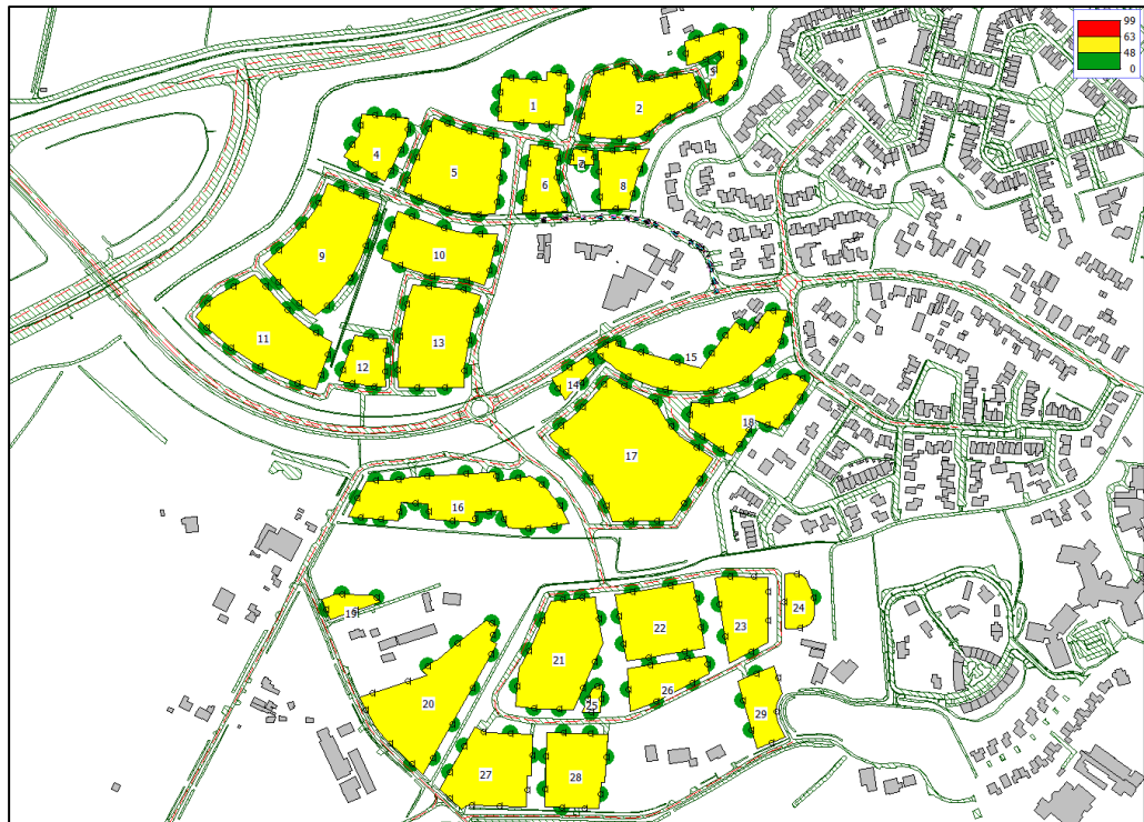
Berekende geluidbelasting vanwege de Oude Doetinchemseweg. Op groene punten is de geluidbelasting \leq 48 dB, op gele punten 48-63 dB, op rode punten > 63 dB.
