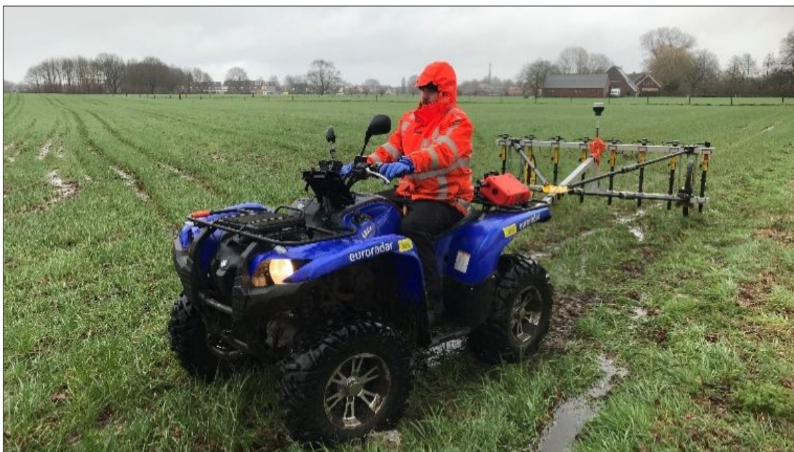
Afbeelding 2: Multisondesysteem met 8 sondes. (bron: Euro radar)
