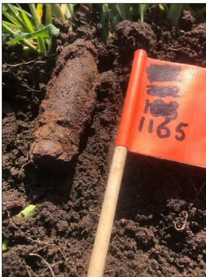
Afbeeldingen 6 en 7: Pantserbrandgranaat van 20mm boordgeschut (GB) en een antitankbrisantgranaat van PIAT (GB). (bron: Euroradar)
