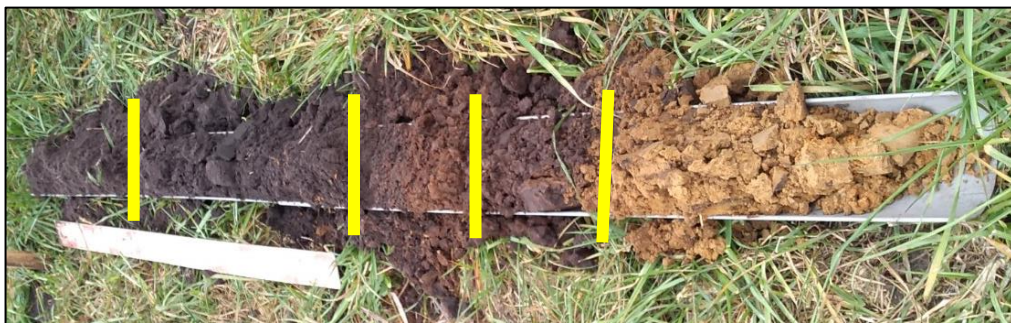
Afbeelding 10: Boring 24 met achtereenvolgens de Ap1-horizont, de A1-horizont, de A2-horizont, de A3-horizont en de C-horizont
