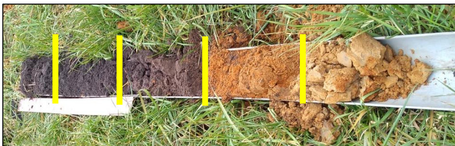
Afbeelding 11: Boring 25 met achtereenvolgens de Ap1-horizont, de A1-horizont, de A2-horizont, de B-horizont en de C-horizont
