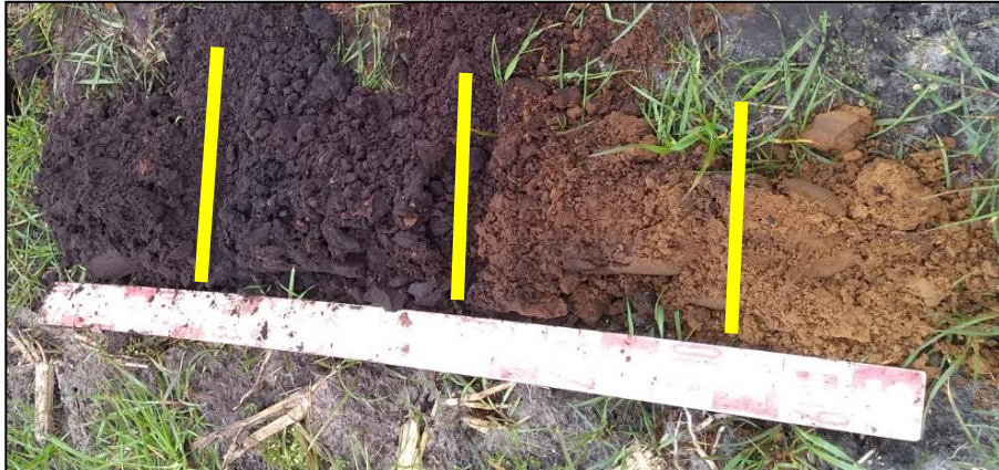
Afbeelding 8: Boring 14 met achtereenvolgens v.l.n.r. de Ap1-horizont, de A1-horizont, de B-horizont en de C-horizont
