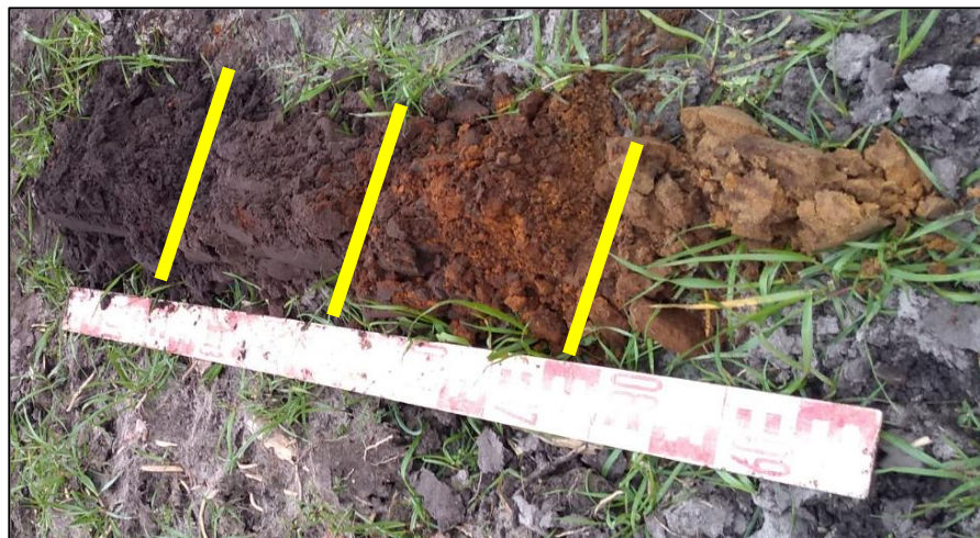
Afbeelding 7: Boring 7 met achtereenvolgens v.l.n.r. de Ap1-horizont, de A1-horizont, een zwak ontwikkelde B-horizont en de C-horizont
