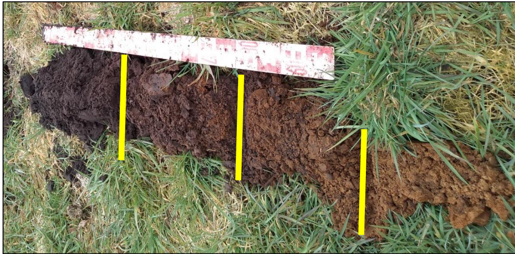
Afbeelding 6: Boring 1 met achtereenvolgens v.l.n.r. de Ap1-horizont, de A1-horizont, een zwak ontwikkelde B-horizont en de C-horizont
