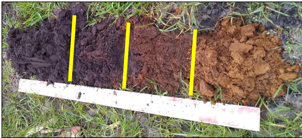
Afbeelding 9: Boring 15 met achtereenvolgens de Ap1-horizont, de A1-horizont, de B-horizont en de C-horizont
