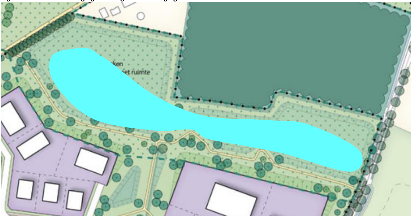
Figuur 3.6 Maaiveldverlaging in beoogde waterberging
