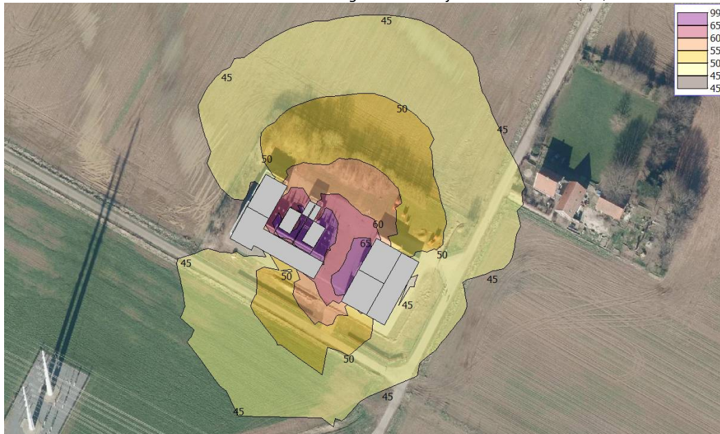
f4.3 Berekende etmaalwaardecontouren exclusief toeslag K_1 voor bedrijfssituatie T1 nullast; T2, T4 en T5 vollast
