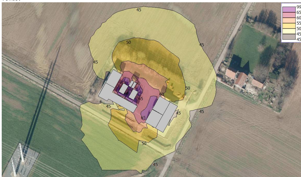
f4.2 Berekende etmaalwaardecontouren exclusief toeslag K_1 voor bedrijfssituatie T1 en T2 50% belast; T4 en T5 vollast
