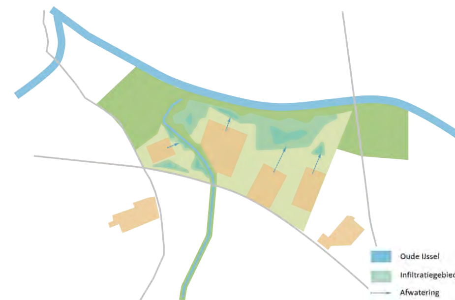
Afbeelding 17 Ruimte voor water: waterberging en infiltratie (circa 850 m3)
