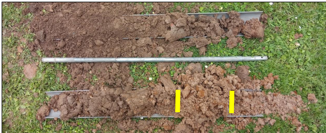
Afbeelding 12: Boring 1, met links van de gele streep de ophooglagen, tussen de gele strepen de menglaag en rechts van de gele streep de natuurlijke ondergrond (terrasvlakke)
