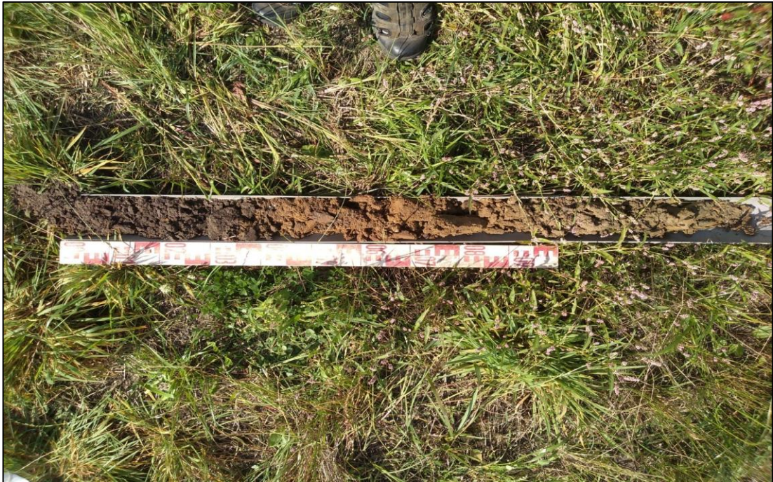
Afbeelding 11: Foto van het bodemprofiel van boring 7 met van links naar rechts de Ap1-horizont, de A1-horizont (eerdlaag), de lichtgrijze leemlaag (Laag van Wijchen) en dekzand (C-horizont).
