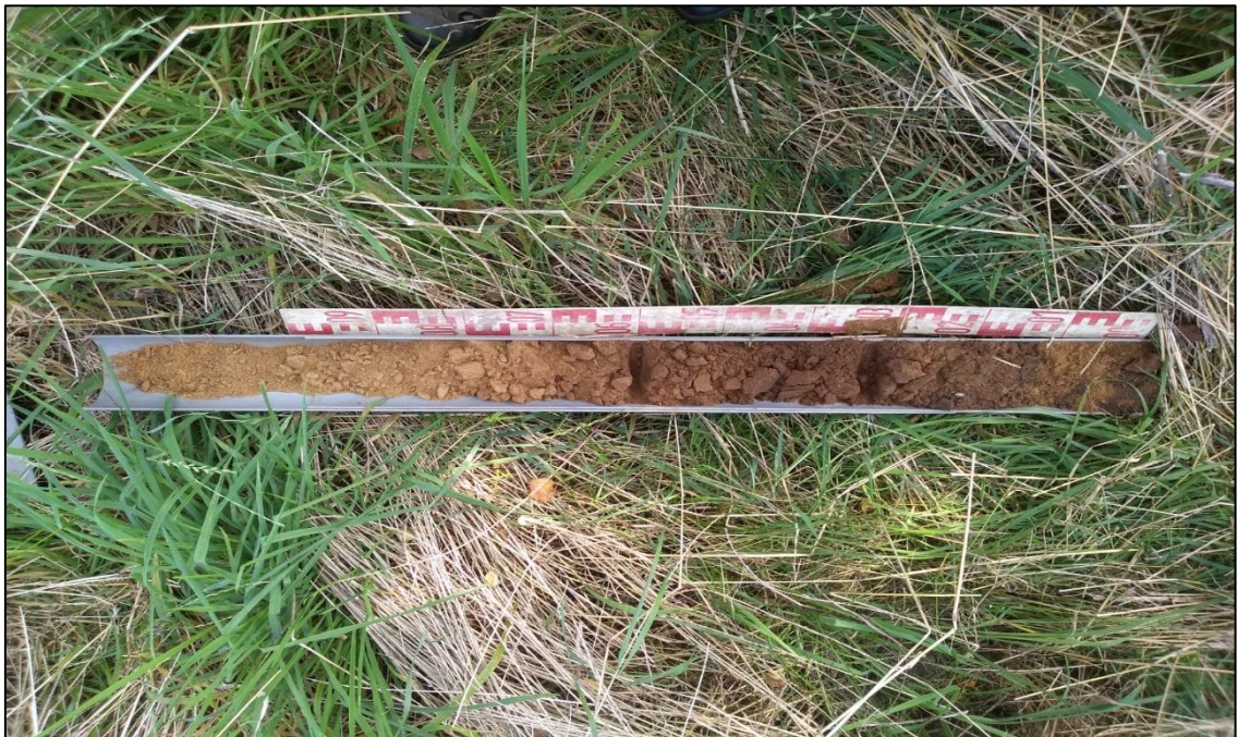
Afbeelding 12: Foto van het bodemprofiel van boring 19 met van rechts naar links de Ap1-horizont, de A1-horizont (eerdlaag) en dekzand (C-horizont).
