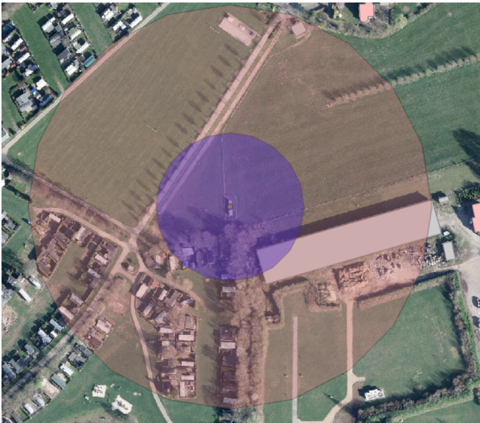
Figuur 3-15, propaantank Scholtenhof met pr en gr contour
