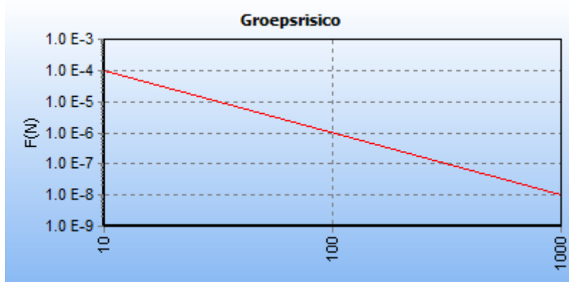
5.6 Figuur 5.6 FN curve voor 3490_leiding-N-569-87-deel-1 van N.V. Nederlandse Gasunie voor de kilometer tussen stationing 0.00 en stationing 1000.00
