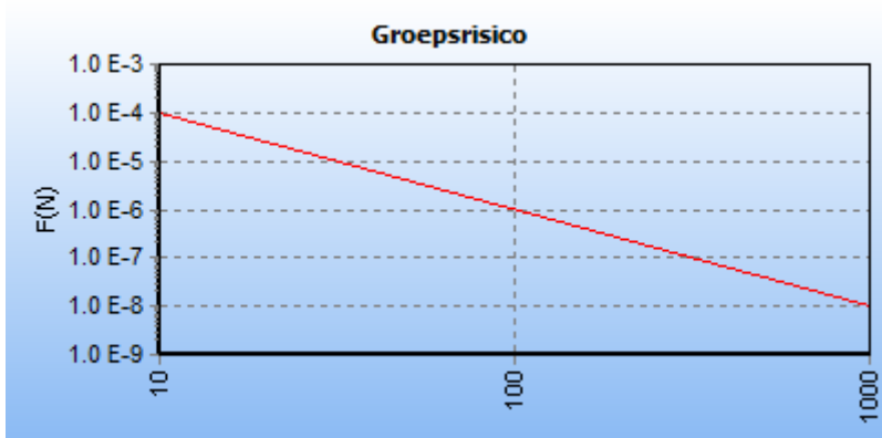
5.2 Figuur 5.2 FN curve voor 3489_leiding-N-569-68-deel-1 van N.V. Nederlandse Gasunie voor de kilometer tussen stationing 0.00 en stationing 1000.00
