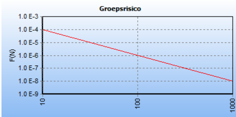
5.2 Figuur 5.2 FN curve voor 3489_leiding-N-569-68-deel-1 van N.V. Nederlandse Gasunie voor de kilometer tussen stationing 0.00 en stationing 1000.00
