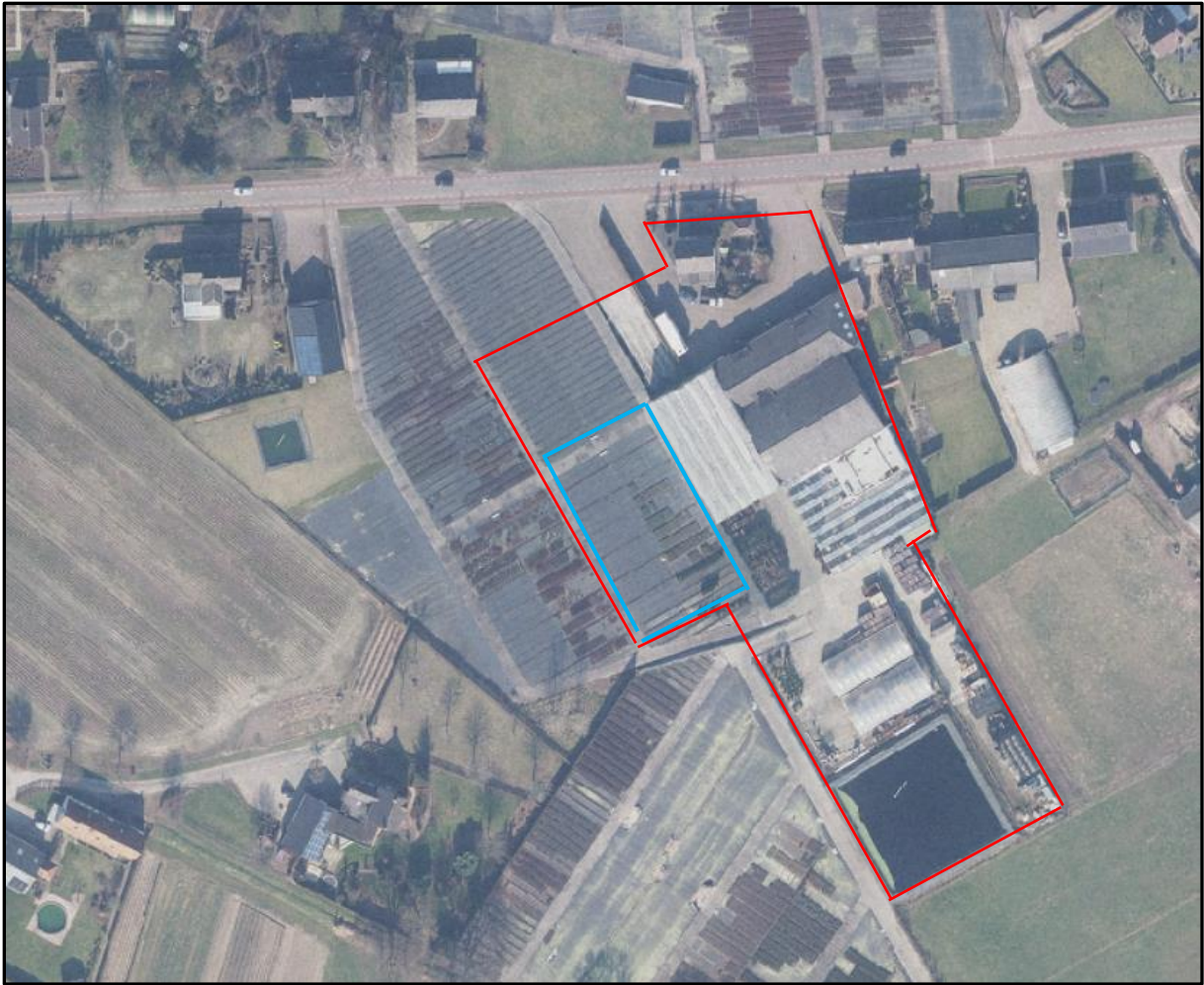
Afbeelding 3: voorgestelde omvang van het bouwvlak (nieuwe kas is blauw omlijnd), daarboven komt verharding met laaddock. Oppervlak 0.98 hectare in totaal.
