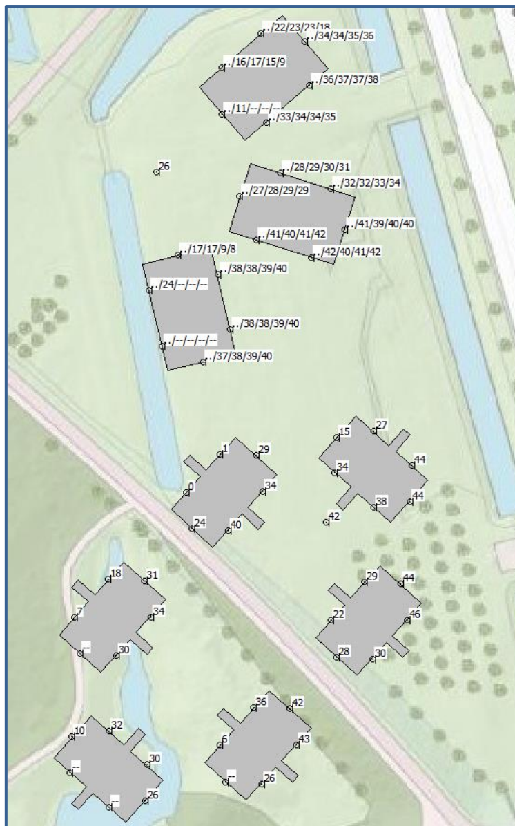
Afbeelding 7. Geluidbelastingen L_{den} (incl. aftrek art. 110g Wgh) Geldersedreef Berekende geluidbelastingen op een hoogte van 1,5 / 4,5 / 7,5 / 10,5 / 13,5 meter
