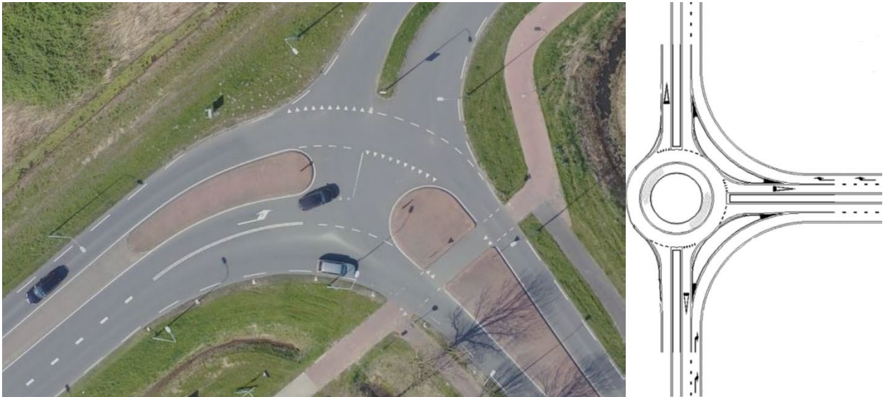
Figuur 5.5: huidige situatie Kruispunt Houtribweg – Visarenddreef (links) en schetsmatige weergave rotonde met bypasses (rechts)
