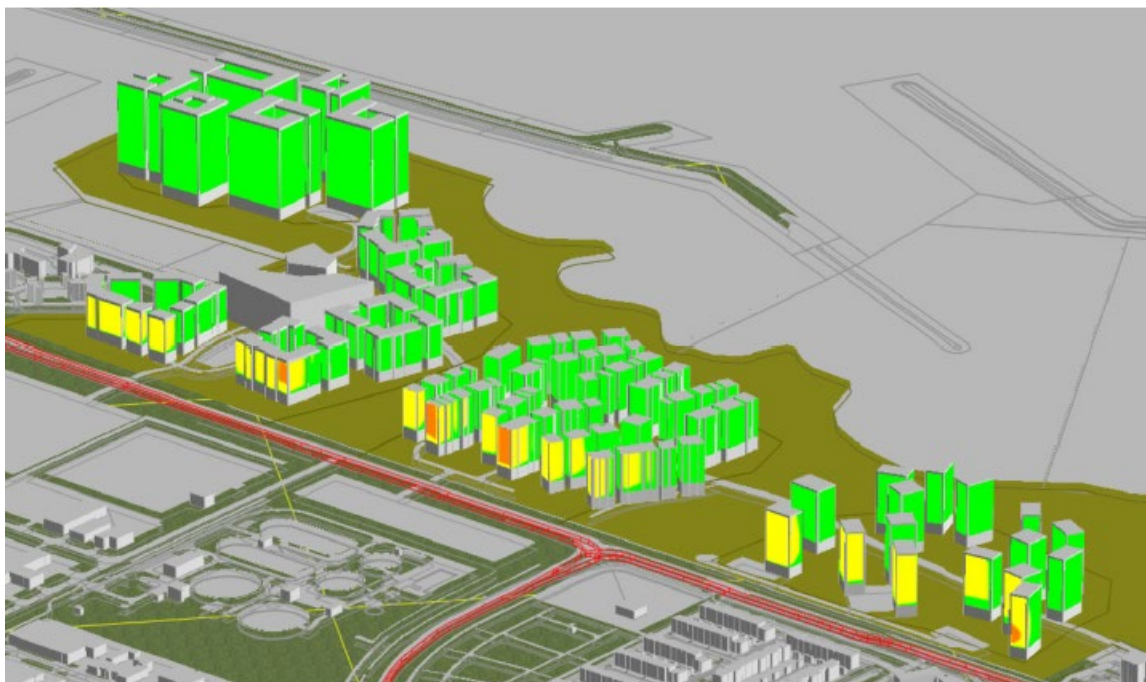
Figuur 5.18: Maximale geluidbelasting (incl. art. 110g Wgh) t.g.v. Houtribweg
