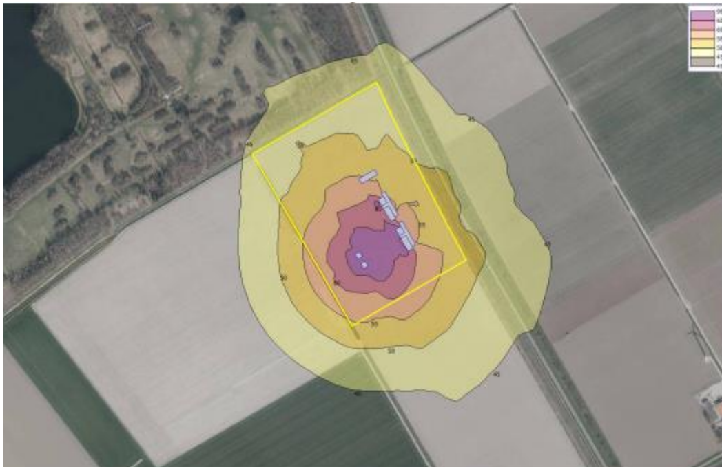
Figuur 7: Berekende etmaalwaardecontouren excl. toeslag voor tonaal geluid ( K_1 = 5 dB), voor de eindfase.
