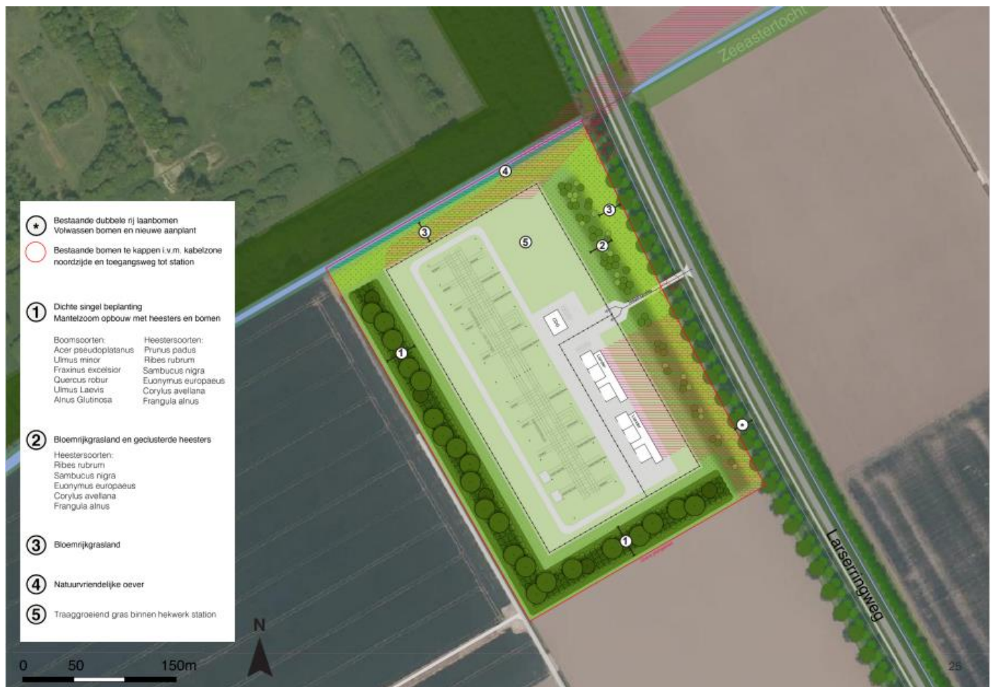
Figuur 8: Landschappelijk inpassingsplan 150/20kV hoogspanningsstation
