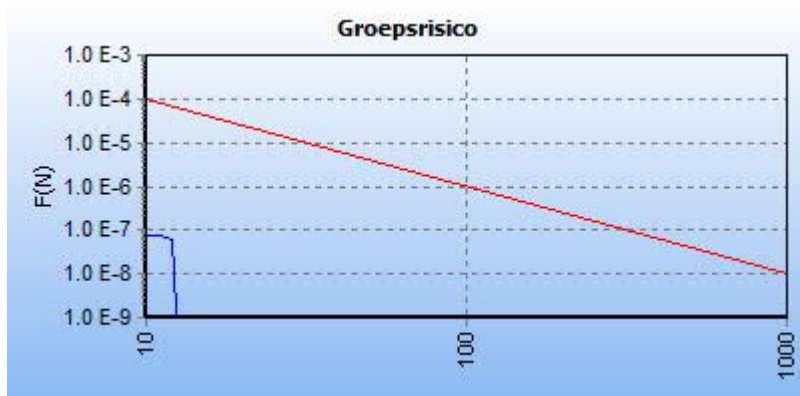
5.3 Figuur 5.3 FN curve voor 7544_leiding-A-655-deel-1 van N.V. Nederlandse Gasunie voor de kilometer tussen stationing 2900.00 en stationing 3900.00
