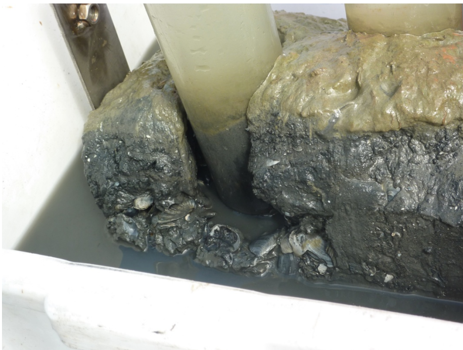
Figuur 8.2: Bodemmonster ter hoogte van slibvangeul, van boven naar beneden: sliblaag, holoceen klei, oude Zuiderzeelaag met schelpenbank (foto: E. Ebbens, 4 juni 2013).
