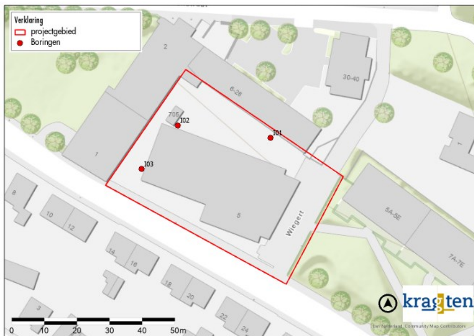
Figuur 8 locaties boringen en infiltratiemetingen
