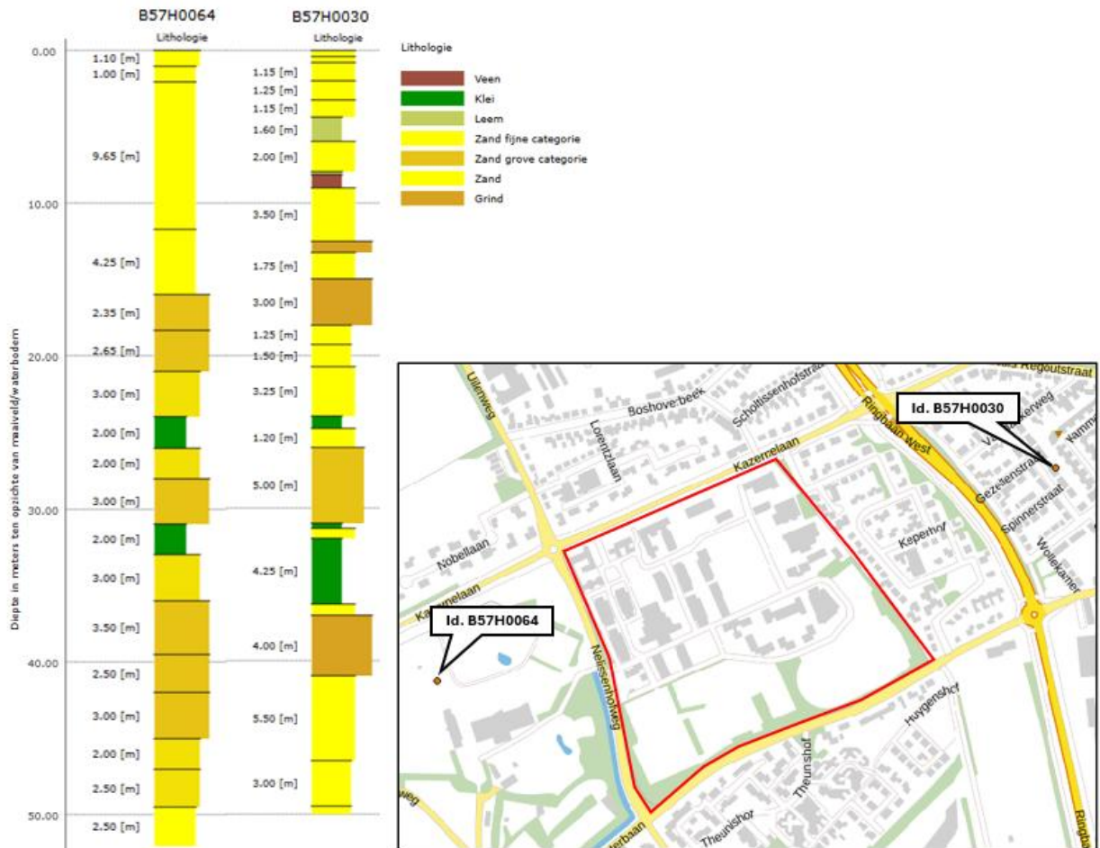
Figuur 2-8: Locaties en boormonsterprofielen van grondboringen B57H0064 en B57H0030 (bron: DINOLOket).
