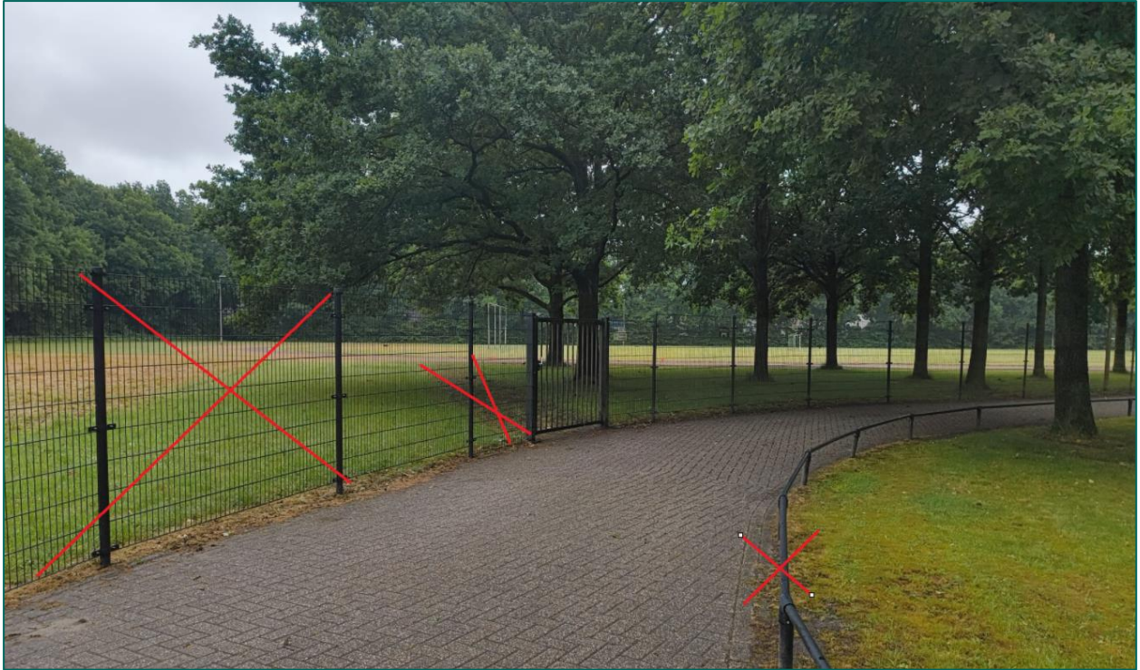
Figuur 39: Geadviseerd wordt om het hekwerk (linkse rode kruis), verharding (middelste rode kruis), zie volgende foto, en het lage hekwerk (rechtse rode kruis) voorafgaand aan het NGE-bodemonderzoek te verwijderen.
