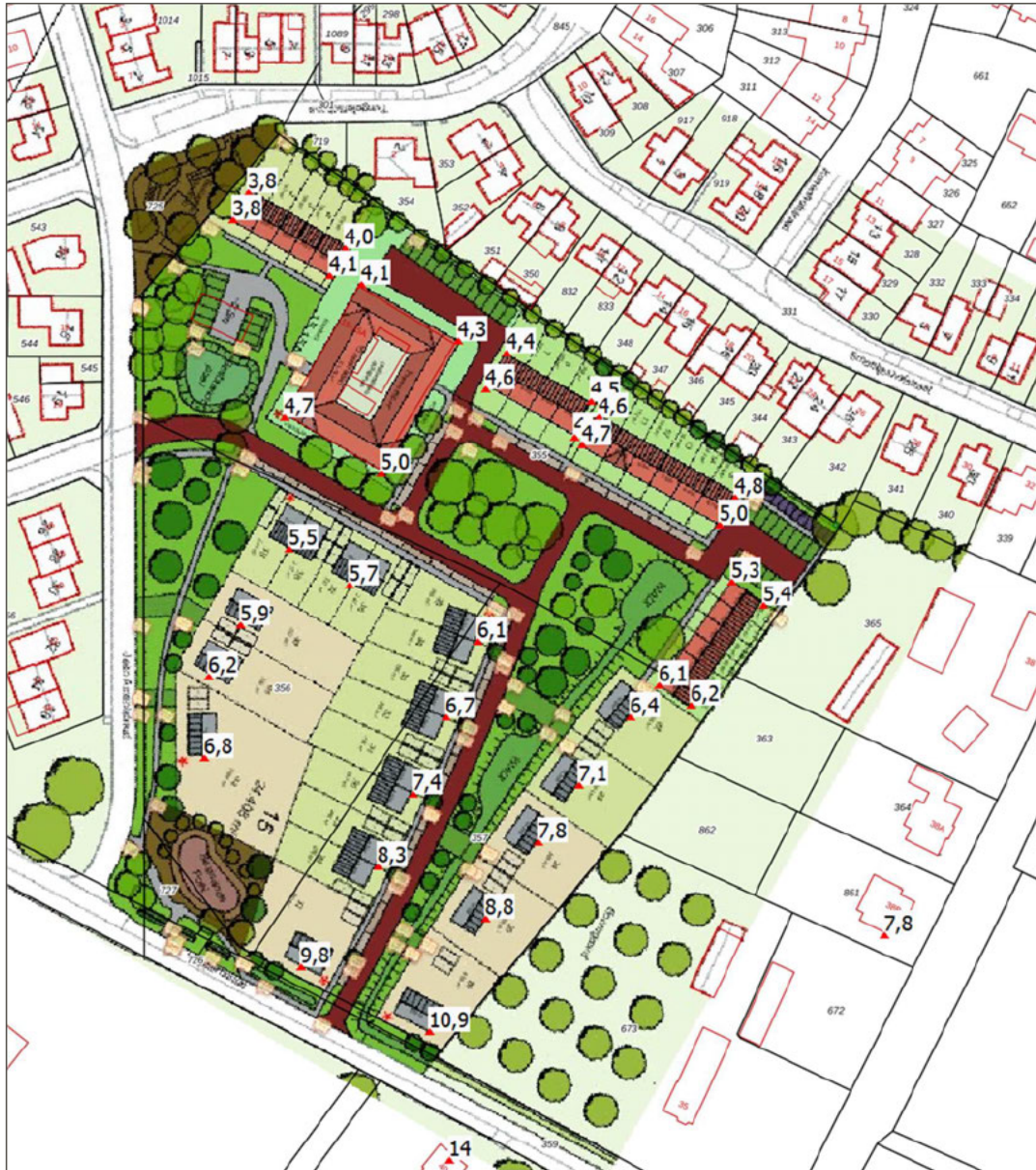
Afbeelding 9 Berekende voorgrondgeurbelasting [ OU_E/m^3 ] o.b.v. 'omgekeerde werking' ten gevolge van de veehouderij aan de Kievitspeelweg 39/40 ter plaatse van de woningen binnen het plangebied
