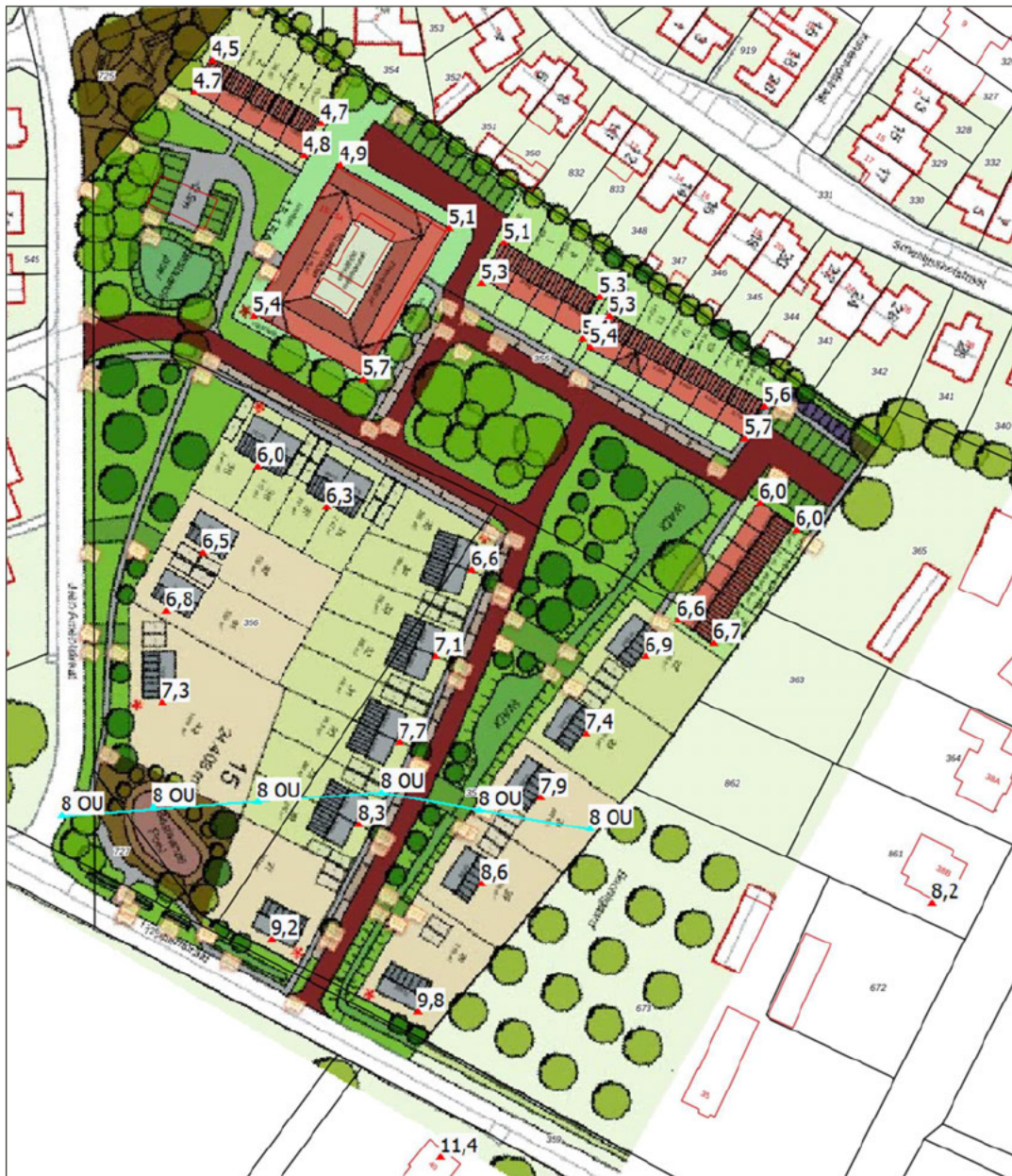
Afbeelding 6 Berekende geurcontour (blauwe lijn) van de voorgrondgeurbelasting [ OU_E/m^3 ] ten gevolge van de veehouderij aan de Kievitspeelweg 39/40 o.b.v. de vigerende milieurechten.
