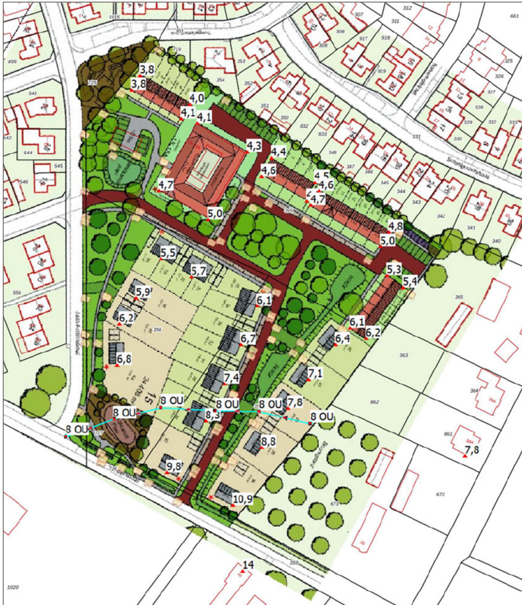
Afbeelding 10 Berekende geurcontour (blauwe lijn) van de voorgrondgeurbelasting [ OU_E/m^3 ] ten gevolge van de veehouderij aan de Kievitspeelweg 39/40 o.b.v. 'de omgekeerde werking'
