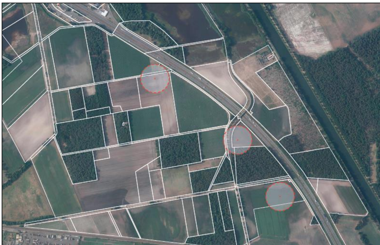
Luchtfoto plangebied met positionering windturbines (masten t.p.v. rode stippen en overdraai t.p.v. rode stippellijn)
